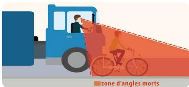
Il existe **quatre zones de visibilité discontinue** autour du véhicule lourd : à l'avant, à l'arrière et sur les côtés !
